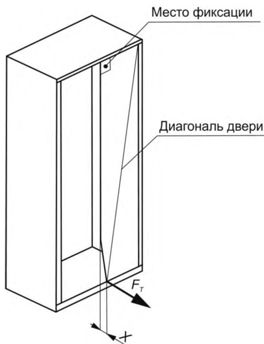
Рисунок 3 – Испытания распашных дверей на жесткость при скручивании
